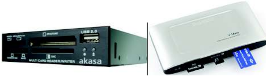
Şekil 109. Solda dahili, sağda harici çoklu kart okuyucular.
