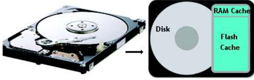
Şekil 45. HDD disk dıştan görünüş ve sağda bileşenleri
