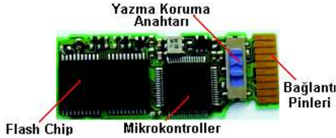
Şekil 102. Hafıza kartı içyapısı ve bileşenleri
