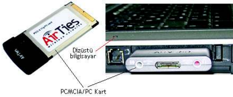
Şekil 13. PCMCIA/PC yapıda; solda, kablosuz ağ kartı ve sağda, dizüstü bilgisayara takılmış bir ses kartı
