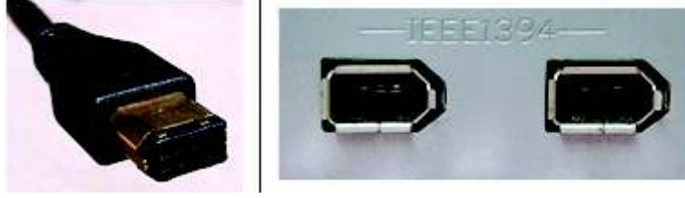
Şekil 12. IEEE1394 Firewire kablo ve port konektörleri
