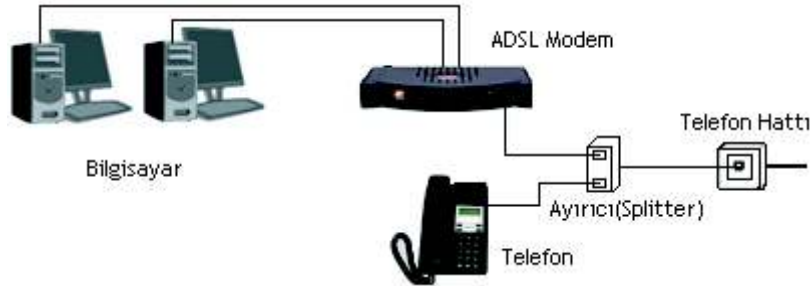
Şekil 72. ADSL modem bağlantı şekli
