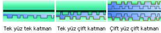
Şekil 64. DVD yan kesitinden katman ve yüz gösterimi(howstuffworks.com)
