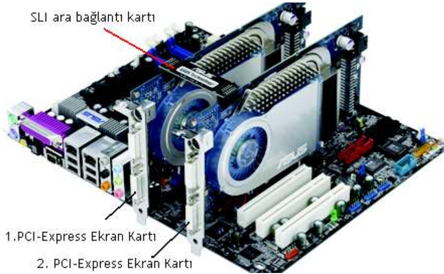
Şekil 18. İki PCI-Express ekran kartının anakarta bağlanmış şekli
