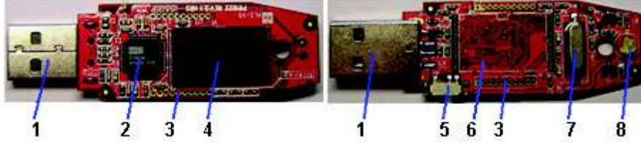
Şekil 100. Flash bellek içyapısı ve bileşenleri
