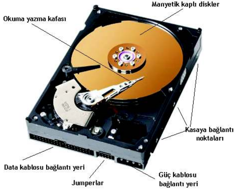
Şekil 35. Sabit diskin iç yapısı ve teme bileşenleri
