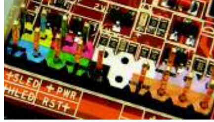
Şekil 22. Anakart üzerinde güç ve reset buton bağlantı pinleri ile HDD okuma/yazma ve güç aktif LED bağlantı pinleri
