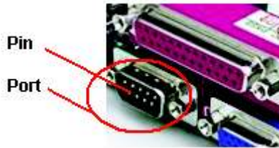
řekil 5. Port ve pin yapıları
