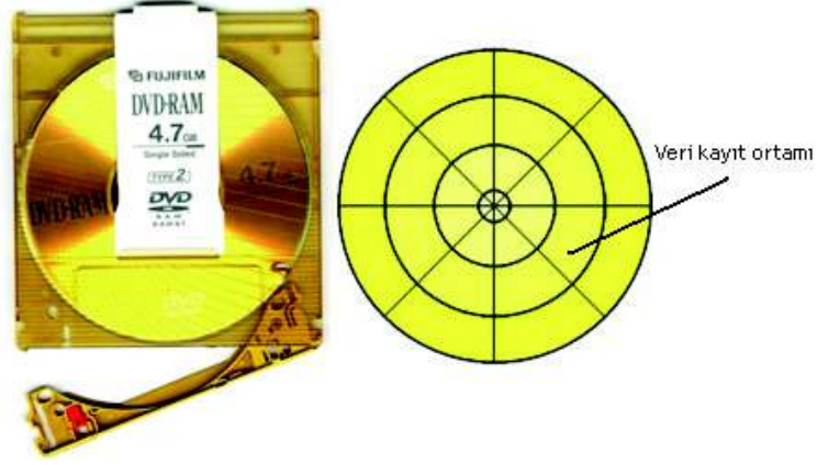
Şekil 66.Orjinal kabı içerisinde DVD-RAM ve solda kayıt formatı
