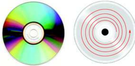
Şekil 58. Optik disk ve veri kayıt biçimi
