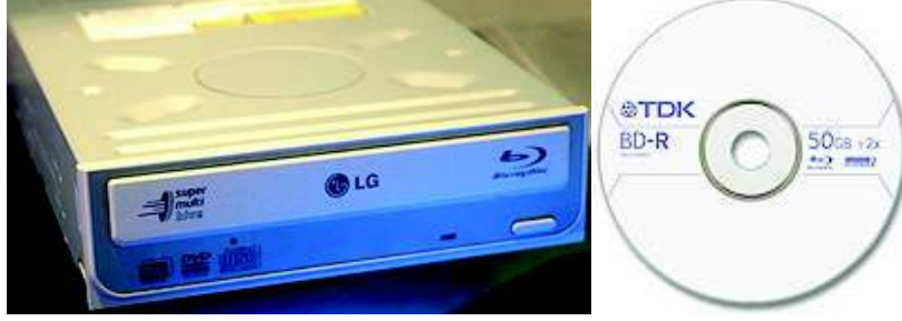
Şekil 67. Solda CD, DVD ve Blu-Ray yazıcı/okuyucu. Sağda Blu-Ray disk.
